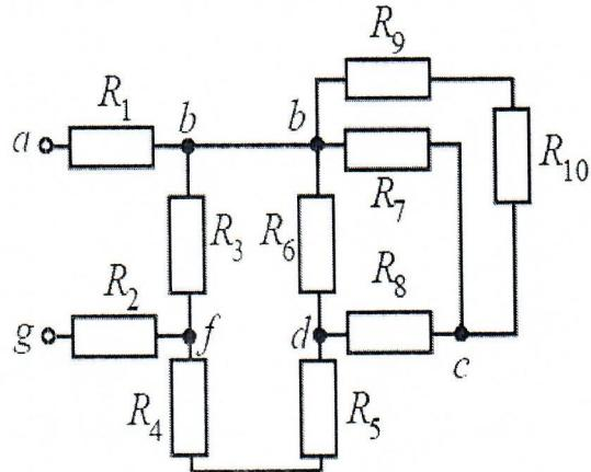
**Задача** Определить для данной цепи эквивалентное сопротивление относительно зажимов  $a-b$ , если  $R_1 = R_2 = R_3 = R_4 = R_5 = R_6 = 10 \Omega$ .
