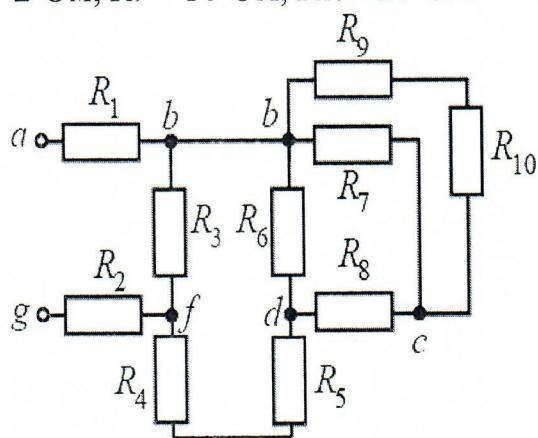
**Задача** Определить для данной цепи эквивалентное сопротивление относительно зажимов  $a-b$ , если  $R_1 = R_2 = R_3 = R_4 = R_5 = R_6 = 10 \text{ Ом}$ .
