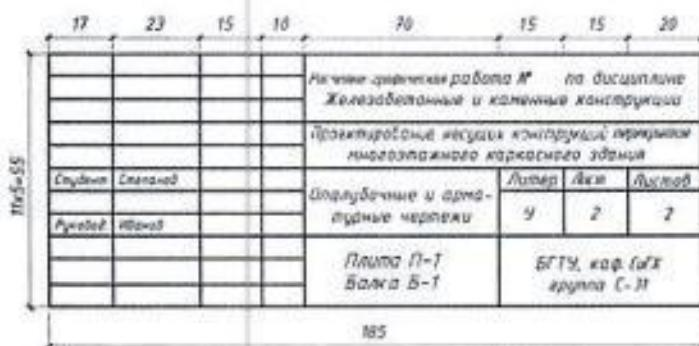
Рис. 9. Угловой штамп РГЗ по дисциплине «Железобетонные и каменные конструкции».
