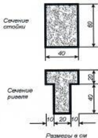
Рис. 2. Сечения элементов рамы
