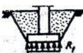
Рис. 1.3. Фундамент, возводимый в открытом котловане: R<sub>1</sub> - нагружение по подошве.
