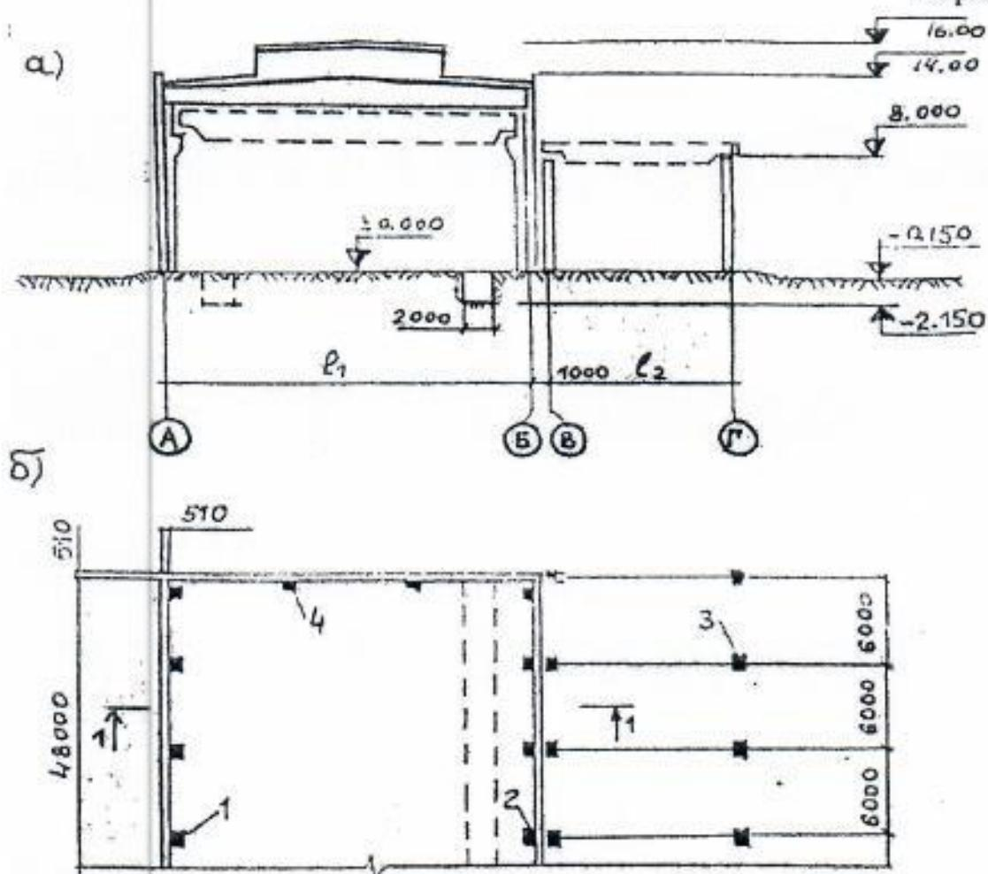
Рис. Схема здания механического цеха, М1:400:
