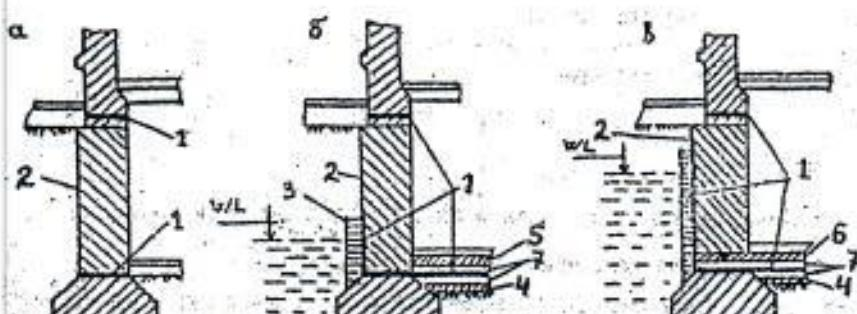
Рис. 15. Гидроизоляция подвальных помещений: а— при уровне подземных вод ниже пола подвала; б — при уровне подземных вод выше пола подвала; в - в то же, при высоком стоянии; 1 - рулонная гидроизоляция; 2.- обмазка битумом за два раза; 3 -прижимная стенка; 4 - бетонная подготовка; 5 - пригрузочный бетон; 6 - железобетонная плита; 7 — цементная стяжка.
