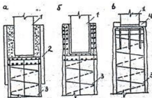
Рис. 13. Сопряжение буронабивной сваи с колонной: а — с помощью кольцевой посадки; б - устройством стакана в свае; в - сварным стыком; 1 - колонна; 2 -насадка; 3 - свая; 4 - сварной стык.
