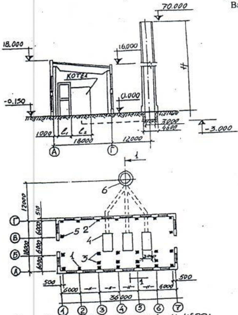
Рис. Схема здания котельной, м 1:500:
