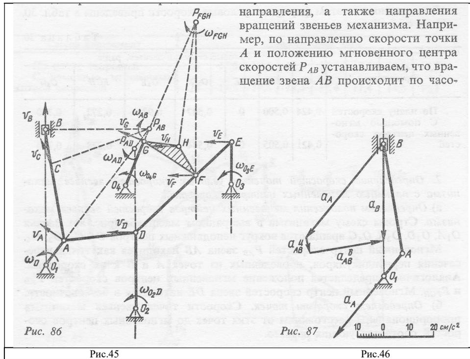
Звенья  $O_1A, O_2D, O_3E, O_4G$  вращаются вокруг неподвижных центров  $O_{1-4}$ .
