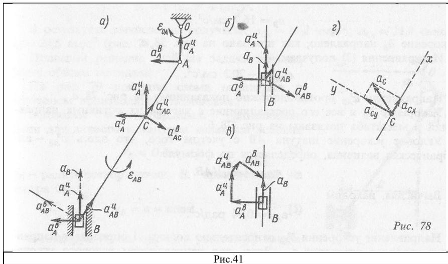
$$\vec{a}_B = \vec{a}_A + \vec{a}_{AB}^b + \vec{a}_{AB}^z$$
