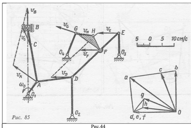
Строим план скоростей. Из произвольного выбранного полюса  $O$  проводим луч  $Oa$ , изображающий в выбранном масштабе скорость точки  $A$ . Для определения скорости точки  $B$  через полюс  $O$  проводим прямую, параллельную скорости  $\vec{v}_B$ , через точку  $a$  – прямую, перпендикулярную  $AB$ . Получаем точку  $b$ ; отрезок  $Ob$  определяет скорость точки  $B$ . Измеряем длину луча  $Ob$  и, пользуясь масштабом скоростей, находим  $v_b = 17,5 \text{ см/с}$ .
